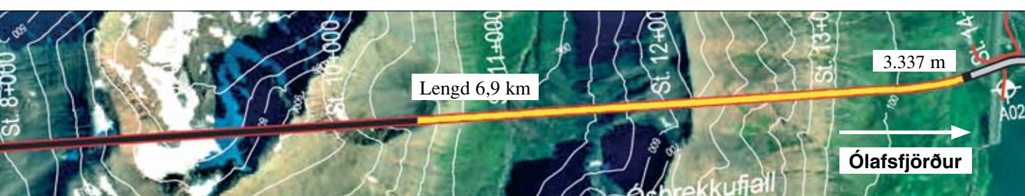
Búið er að sprengja 591 m í Héðinsfirði og 3.337 m í Ólafsfirði. Samtals 7.568 m sem er 71,5 % af heildarlengd.
